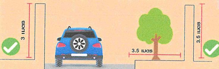
รั้วบันไดสูงได้สูงไม่เกิน 3 เมตร โดยวัสดุทั่วไปคือดักทางเดินหรือถนนสาธารณะ แต่ต้องสูงกว่า 3 เมตร ต้องเป็นรูปไข่ค้างสูงจากผู้เดินบินไม่ให้สูงกว่าความสูงของรั้ว
